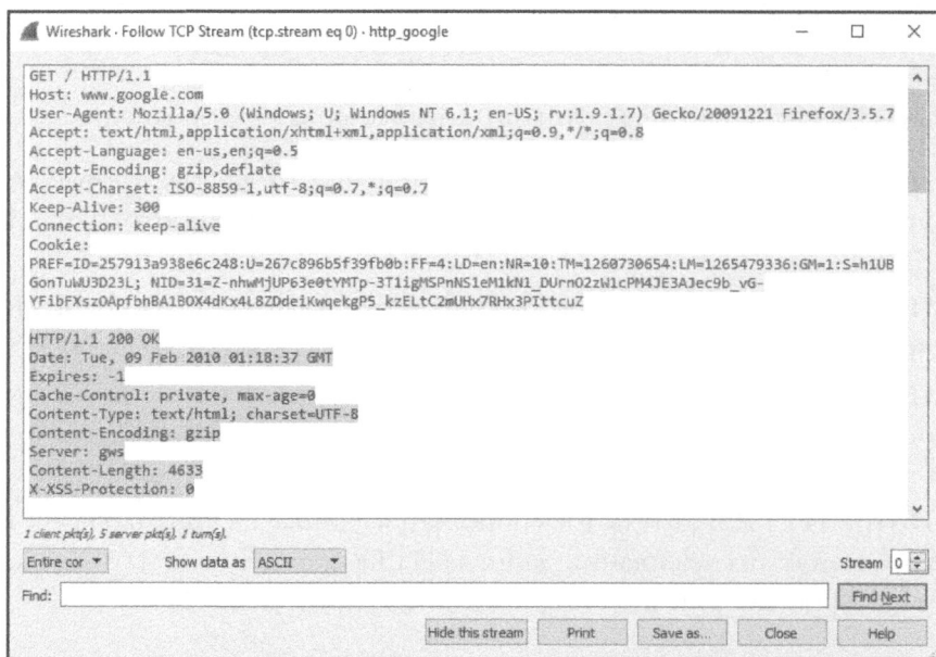
Рис. 5.14. В окне Follow TCP Stream повторно собранные передаваемые данные представлены в удобочитаемом формате
